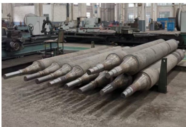
图11 CNRE超高温稀土耐热钢炉底辊产品照片 Fig. 11 Photo of CNRE furnace bottom roller products
